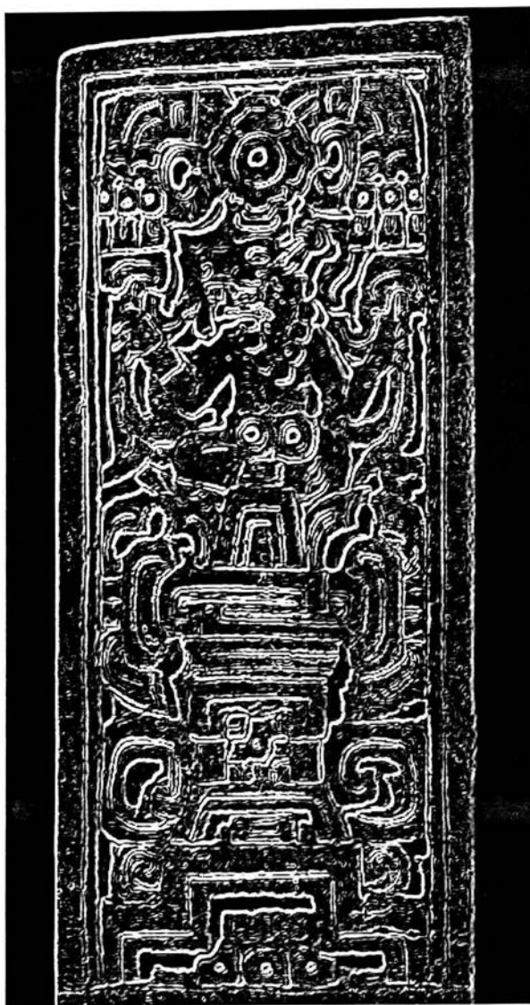
Figura 4.13: Imagen resultante de la localización de bordes aplicado a la imagen de la figura 4.4.
