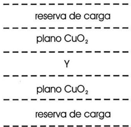
Figura 2.6: Modelo de las capas del YBa_2Cu_3O_7 .
