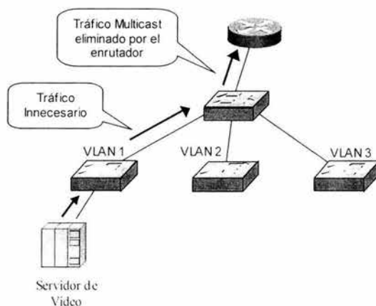
Figura 4.19 Problema de enlaces entre switches
