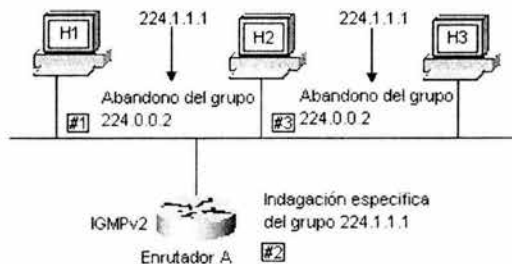
Figura 3.22 Proceso de abandono utilizando IGMPv2
