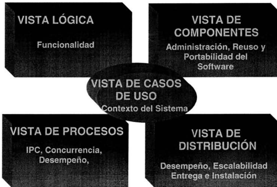
Fig. 3.1 Puntos de vista de UML para la modelación de un sistema de software de calidad
