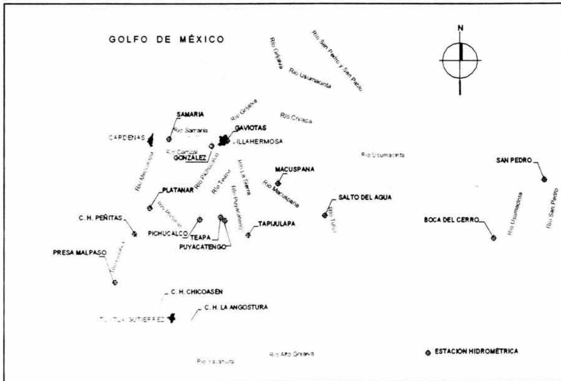
Figura 4.3 b) Planta del Sistema Hidroeléctrico del Río Grijalva. (Gerencia Regional Frontera Sur, CNA)
