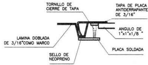
7 CORTE C-C' REGISTRO PARA CISTERNA ESC: S/E
