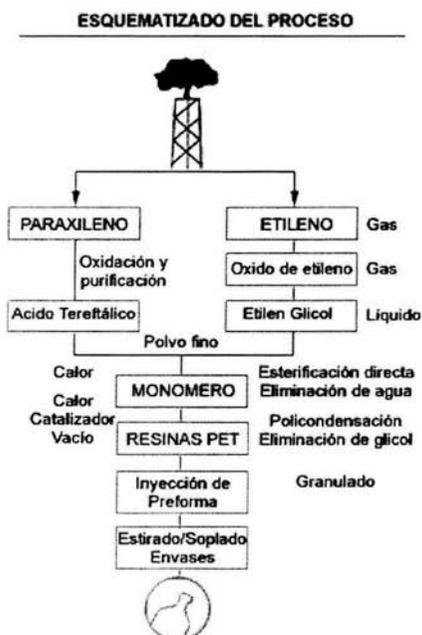
Fig. 4 Esquema del proceso para la producción de envases de PET.
