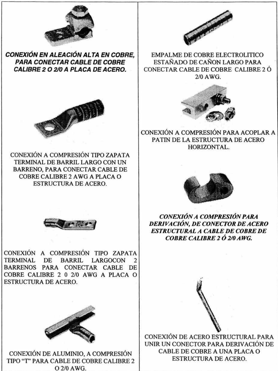
FIGURA NO 4.2 CONECTORES A COMPRESIÓN UTILIZADOS EN EL DISEÑO DEL SISTEMA DE TIERRAS Y PARARRAYOS.
