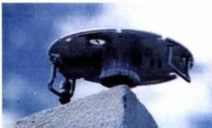
Receptor GPS. Estación Fija
