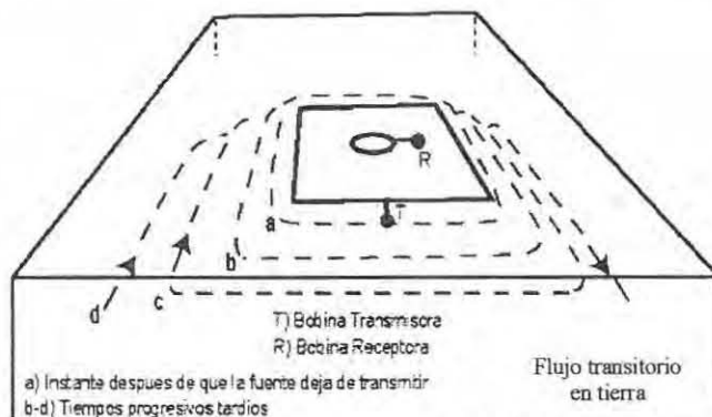
Figura 29 Ejemplo esquemático del funcionamiento del TEM con bobina central de recepción.
