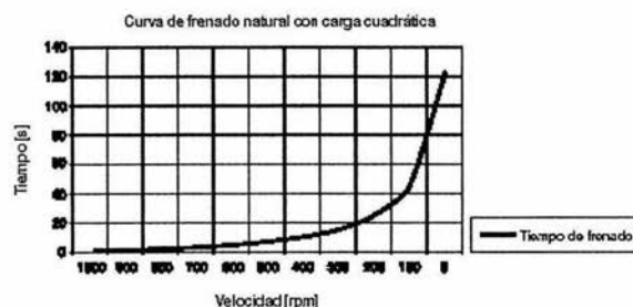
Figura 2.3 Tiempo de frenado acumulativo de un ventilador de 90 Kw.
