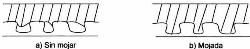
FIGURA I-2 Mojado de un sustrato sólido por un adhesivo fluido.
