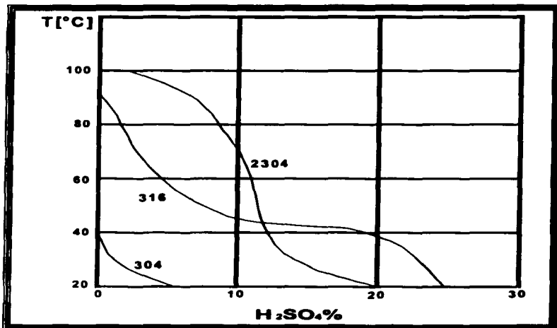
Figura 8.2 Curvas de isocorrosión a 0.1 mm/año de los aceros 2304, 316 y 304
