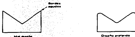
Figura 7.1 Los polvos metálicos no llenan bien los dados que tienen bordes agudos. Deben preferirse diseños con aristas redondeadas.
