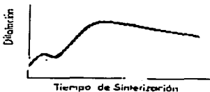
Figura 8.3 Cambios dimensionales que ocurren en la sinterización de compactos de polvos elementales (90% Cu y 10% Sn) vs tiempo de permanencia a la temperatura de sinterización.
