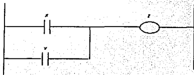
Figura 2.11 Con las instrucciones programadas en paralelo, la salida Z será Verdadera (On) si uno, ya sea X o (OR) Y son Verdaderas (On)
