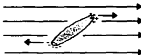
Fig. 21 Representación esquemática de la influencia de un campo eléctrico sobre una molécula de cristal líquido (R. Moldovan, M. R. Paica, 2001)
