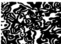
Fig. 33 Efecto de la birrefringencia en una muestra de cristal líquido puesto entre polarizadores cruzados (G. R. Luckhurst, 2000)
