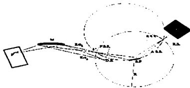
Fig. 64 Difractómetro de laboratorio con configuración Bragg-Brentano (R. E. Dinnebieer y col., 2000)
