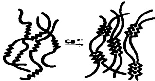
Fig. 47 Modelo "egg-box" para la formación de un gel de Alginato
