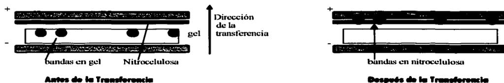
Fig. 132. Transferencia de bandas a papel de Nitrocelulosa por medio de Electroforesis.<sup>110</sup>
