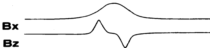
Figura 31. Señales de barrido en una grieta transversal
