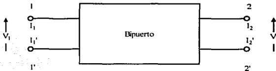
Figura 2.1 Diagrama general de un bipuerto
