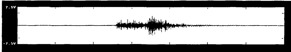
Figura 124 Fuente DIGITALIZADOR: Archivo detectado por el prototipo del sismo en Río Balsas Inferior 01:44:23 2003/03/03, Instalado en las Instalaciones del Instituto de Ingeniería
