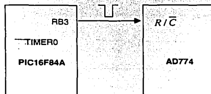
Figura 46 Señal de control de la Frecuencia de Muestreo
