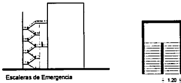
Escaleras de Emergencia
