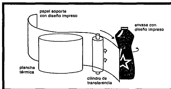
Etiquetas por transferencia de calor.
