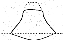
Por asentamiento del bordo o su cimentación
