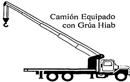
Figura 29.- Grúa empleada en el montaje de Anuncios Espectaculares.
