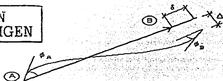
Figura 11.2.4.5. Configuración deformada de una barra de un marco plano.
