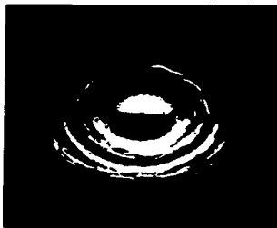
Figura 1.20. Patrón de sombras para una superficie irregular.
