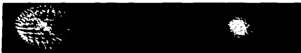
Figura 3.24 Imágenes obtenidas al realizar una prueba de Hartmann a la superficie Baush & Lomb, por transmisión, variando la posición de la rejilla respecto del foco de la superficie.
