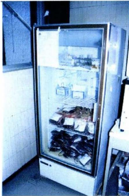
Refrigerador modelo Ojeda para la conservación de sangre no liberada con una temperatura de 1 a 6°C.
