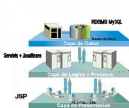
Fig. C2-6 Arquitectura de 3 Capas para el Sistema de Administración de documentos y planos CAD para el IMP
