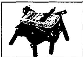
Figura 9a. Primer prototipo de seis patas
