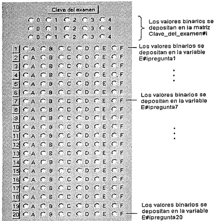
Fig. 5.7b '#i' es el valor numérico de la variable 'i', el cual forma, dinámicamente, parte del nombre de las variables referenciales. <<Clave\_del\_examen#i>> es una matriz de dimensión 3x5: i=1,2,3,..., [9 ó 10]
