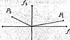
El espectro de la señal muestreada está formado por una réplica infinita del espectro de la señal original centrada en todas las posibles combinaciones enteras de los vectores  $P_1$  y  $P_2$ .
