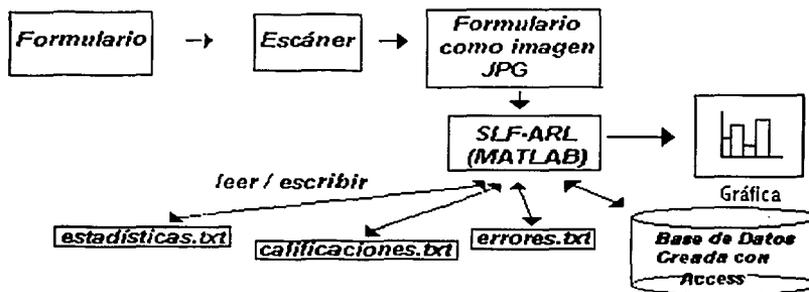
Fig. 5.4 Diagrama de bloques del proceso de evaluación de los exámenes
