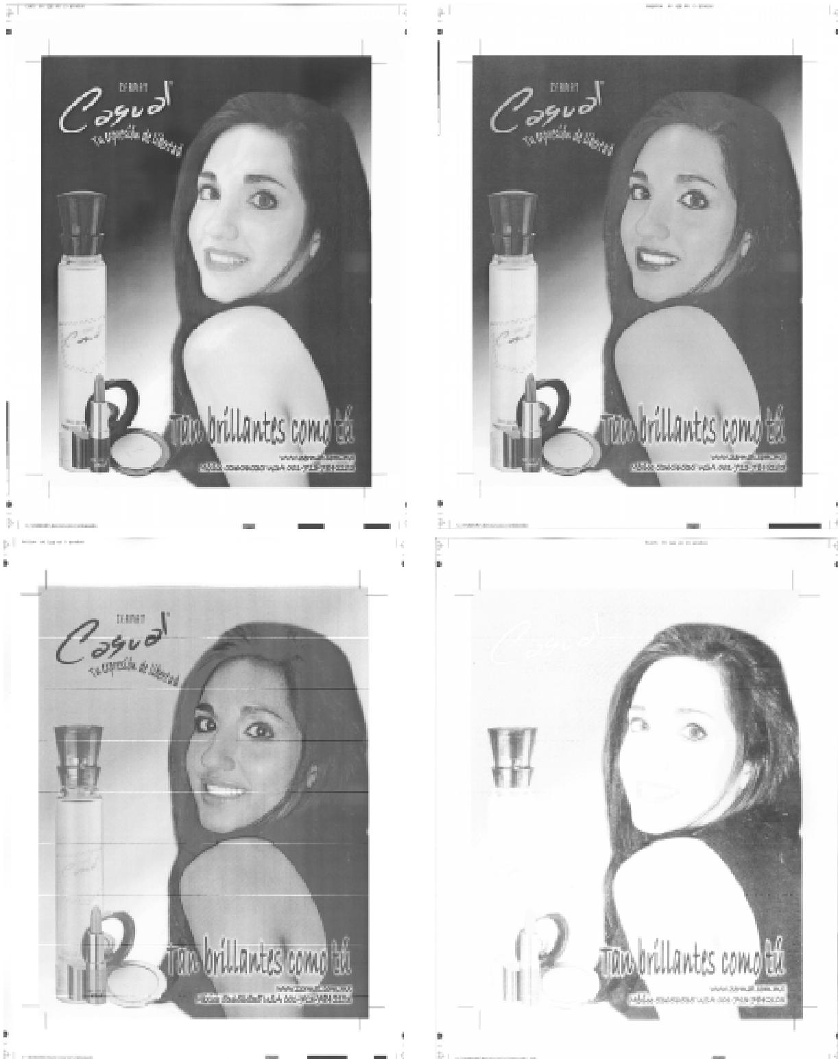
A continuación se muestra la separación de color para la elaboración de las placas que servirán así para hacer los negativos que servirán para hacer las placas que se utilizarán para la impresión en offset.
