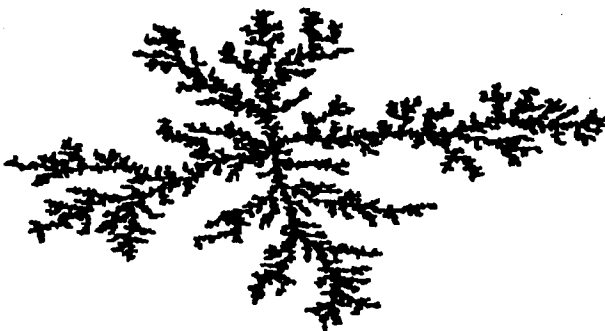
Figura 2.8: Agregado fractal generado por agregación limitada por difusión, la estructura resultante evoca algunas formas que se obtienen en diversos procesos experimentales, así como algunas formas orgánicas.
