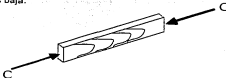
Fig. III.17 Elemento de madera sometido a carga axial paralela a la fibra
