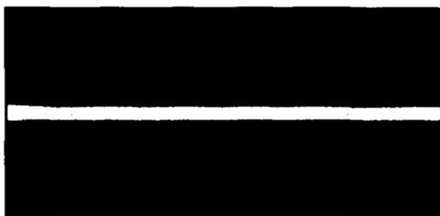
Figura 3-6.2 Se muestra un rayo en una guía de onda plana no-lineal donde se forma un solitón con un ancho de  $10\mu\text{m}$ , de una longitud  $100\mu\text{m}$  y un espesor de  $2\mu\text{m}$  utilizando el Método de Propagación del Rayo de Diferencia Finita.
