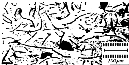
Figura 1.1.- Hierro Gris Eutéctico a 200X sin atacar fundido en arena, donde se observan la hojuelas de grafito.
