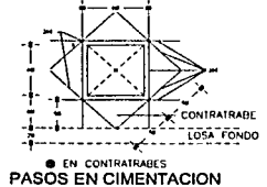
EN CONTRAEBES PASOS EN CIMENTACION
