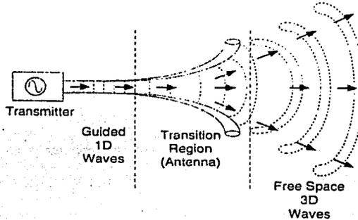
Fig. 2.2 Representación de una antena como una región de transición entre las ondas dirigidas y las propagadas
