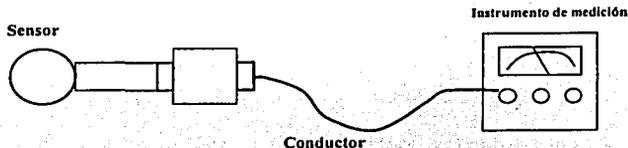
FIGURA 1. Componentes básicos de un instrumento de investigación de RF
