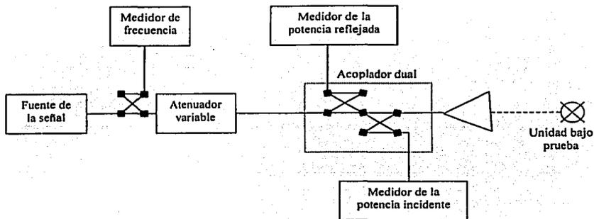
Fig. 2 Método de calibración normalizado para medir el campo en el espacio libre
