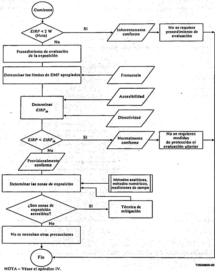
Fig. 2 Diagrama de flujo para evaluar la exposición para una sola fuente de CEM
