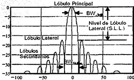
Fig. 2.6 Parámetros del diagrama de radiación
