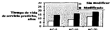
Figura a.3-ix: Comparación del tiempo de vida de servicio del asfalto solo y AM en el estado de Carolina del Norte, EUA. Obtenida de Koch pavement solutions (2002).
