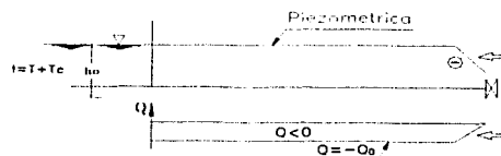
(h) Finaliza la reflexión en la válvula. La onda de depresión parte hacia el tanque
