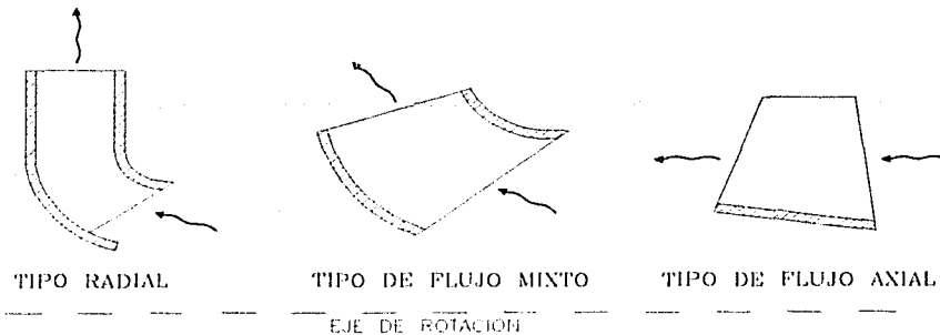
TRAYECTORIAS DE LAS PARTICULAS FLUIDAS A TRAVES DEL IMPULSOR DE BOMBAS DE FLUJO RADIAL, MIXTO Y AXIAL
