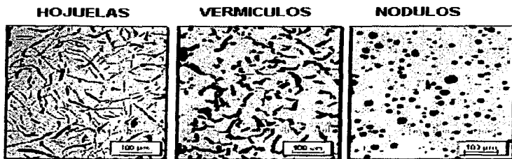
Figura No. 12: Diferentes formas del grafito precipitado.
