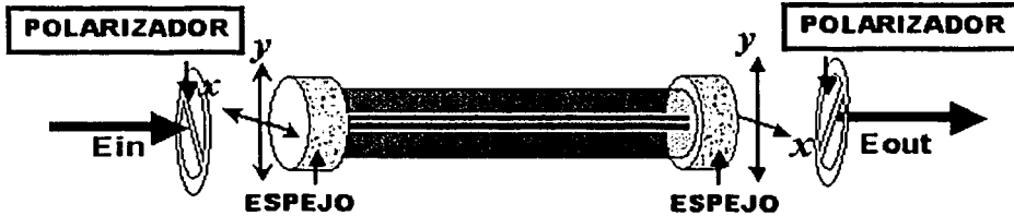
FIGURA 3-30 Interferómetros de MFP de fibra óptica con espejos acoplados a la fibra y polarizadores externos.
