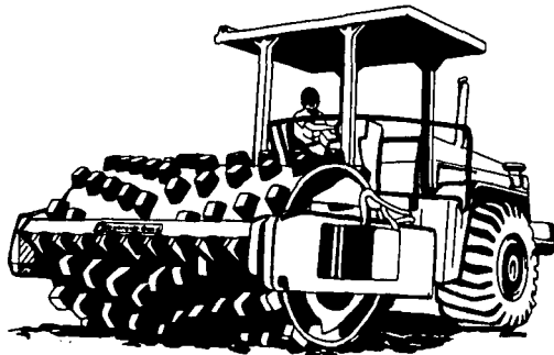
Figura 3-12 Compactador pata de cabra con llantas neumáticas, complementado con dispositivo de vibración.
