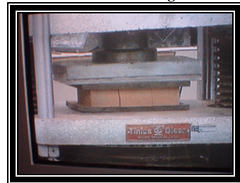
Figura 2.19 a. Pieza de ladrillo VínTEX al producirse las primeras grietas
