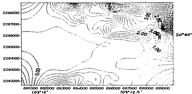
Figura ii.12- Corrección de terreno para el área de estudio de acuerdo a nuestro programa. Los contornos son dados en mGals ( 10^{-5} m/s 2 ). Para referencia se dan coordenadas geográficas y UTM.
