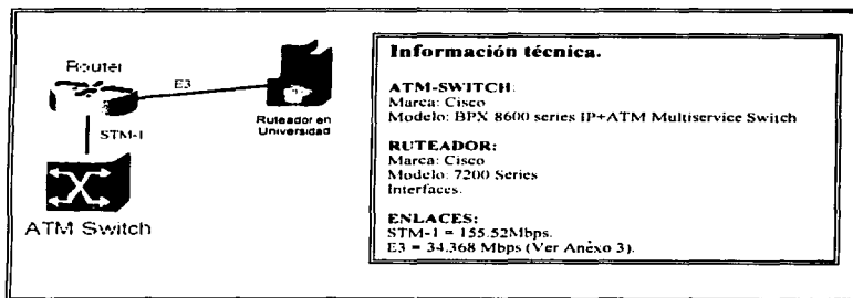
Figura 4 Conexión de los Asociados al Switch ATM
