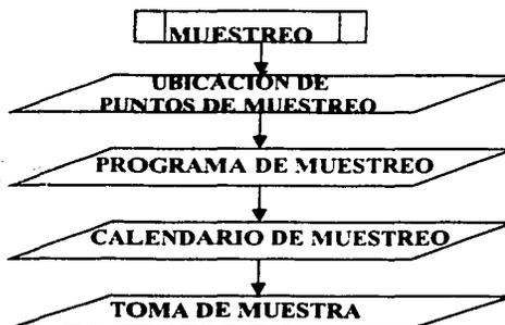
Figura 5.2. Diagrama de bloques de la metodología del muestreo.
