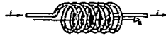
Figura 3.6 Bobina que se le hace pasar una corriente y produce un campo magnético.
