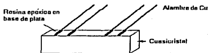
Figura 3.8 Diagrama esquemático del arreglo empleado para la medición de la resistividad por medio del método de las cuatro puntas.
