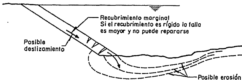
Fig. 3.14 Falla de un recubrimiento no protegido al pie del talud
