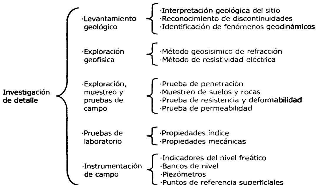
Cuando ya se conocen los datos de la estructura y las características geológicas, es posible determinar las propiedades mecánicas del terreno de cimentación, realizando pruebas de campo y ensayos de laboratorio que se hacen en muestras extraídas del subsuelo.
