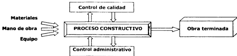
Así con la figura se puede apreciar que con los elementos básicos que son los materiales, la mano de obra y el equipo, al emplear un proceso constructivo, se puede llegar a obtener la obra terminada; y durante la ejecución de ese proceso, en el control administrativo se vigila: el tiempo mediante un programa de obra, y el costo mediante un presupuesto; y con el control de calidad se vigila que se cumplan las especificaciones del diseño tomando muestras y haciendo pruebas.
