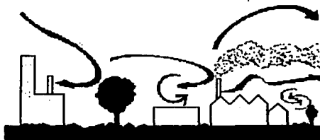
FIGURA 1.6 Turbulencia generada por desviaciones del flujo debidas a obstáculos como árboles o edificios.
